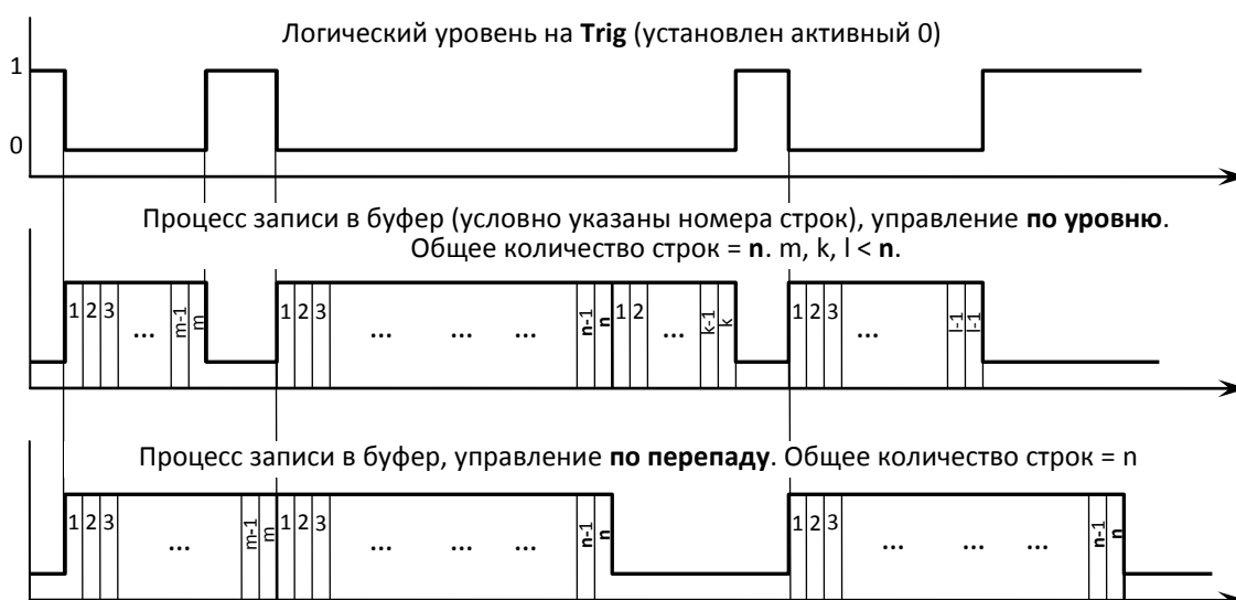
Рисунок 11 – Диаграмма управляющих логических сигналов и процесса записи в режиме « многократная запись » с управлением « по уровню » и « по перепаду »
